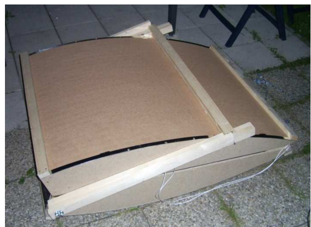
Abbildung 2 : Die Parabolrinne zusammengeklappt, inkl. Beine und Grillpfannenhalterung
