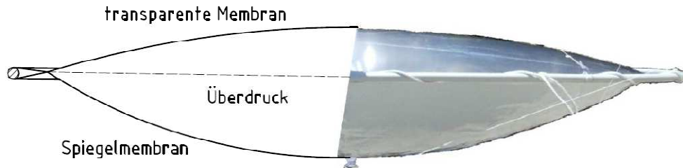
Abbildung 3 : Das Prinzip der aufblasbaren Parabolschüssel in der Seitenansicht
